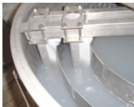
Figuur 12: Bij deze warmtewisselaar wordt het vers water door de tussenwanden en buitenwand gestuurd. Het afvalwater wordt door roterende borstels in turbulentie gehouden, waardoor de platen zuiver gehouden worden (bron: Christeyns).
