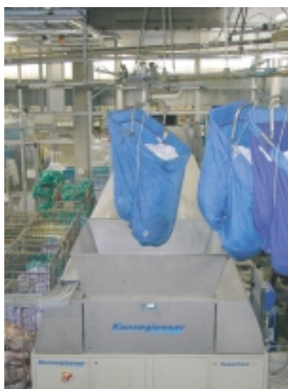
Figuur 2: Optimale belading van een wastunnel door middel van een hangbanensysteem (bron: FBT-innovatiecel).
