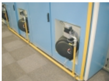
Figuur 28: Rechtstreekse aardgasverwarming op finisher (bron: Streitz).
