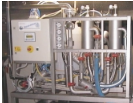
Figuur 14: Filtersysteem van 75 \mu\text{m} en 25 \mu\text{m} -filtratie uitgerust met automatische terugspoeling. Inzetbaar op wastunnels of centrifugerende wasmachines (bron: Ecolab).
